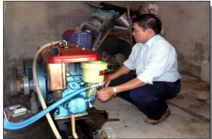
**Máy phát điện sử dụng nhiên liệu biogas**
